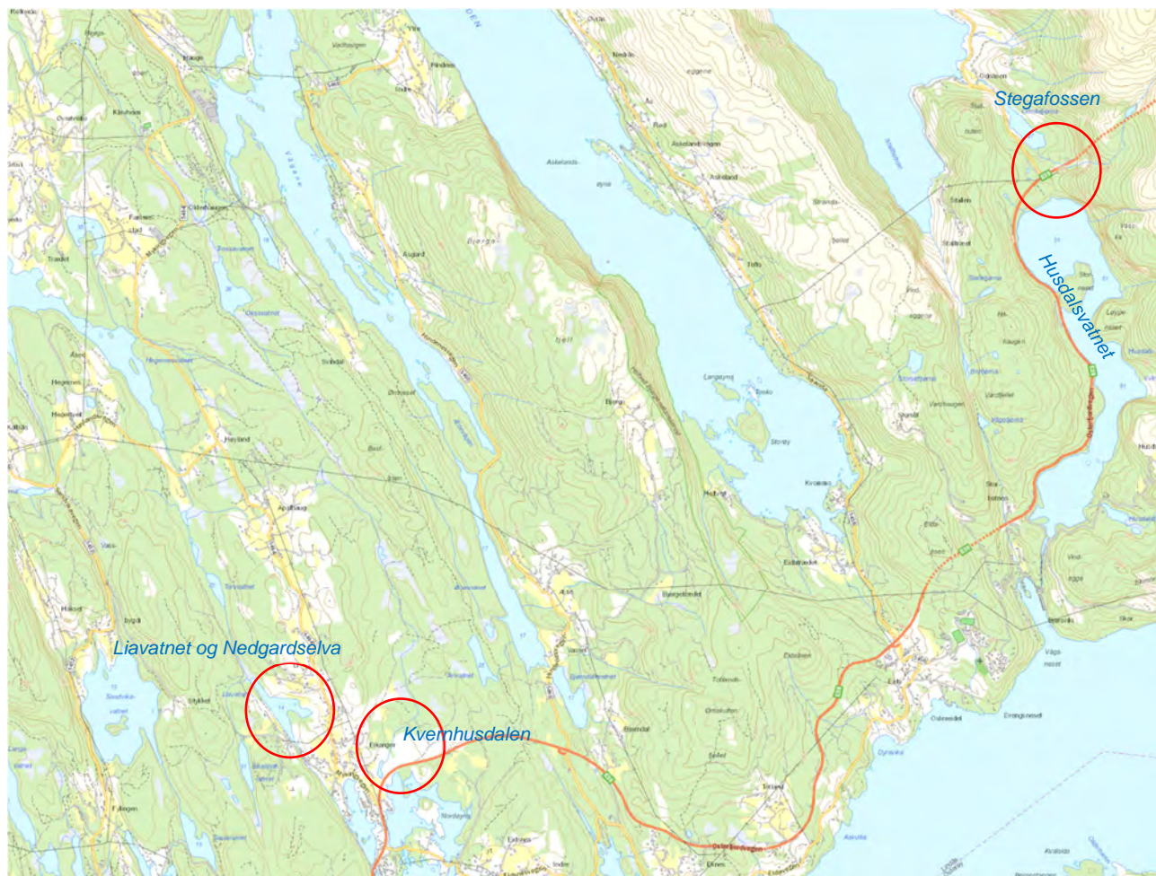
Figur 1-2 Kart som viser dei planlagde krysningane på nye E39 i dei ulike alternativa / områder kor det er utført utrekningar av flaumvassføring og vasslinjeutrekningar.
